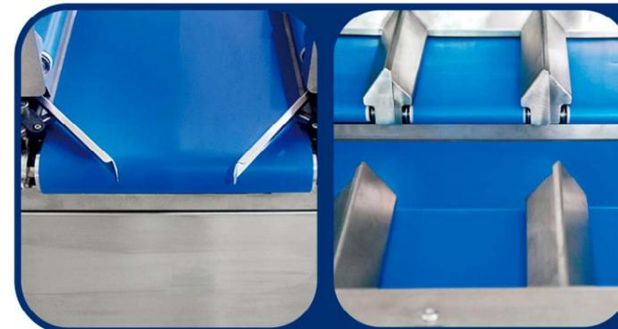
Sistema de dosificado de producto irregular para la industria alimentaria, construido en AISI304, AISI316 y bandas transportadoras diseñadas para un fácil desmontaje y limpieza.
