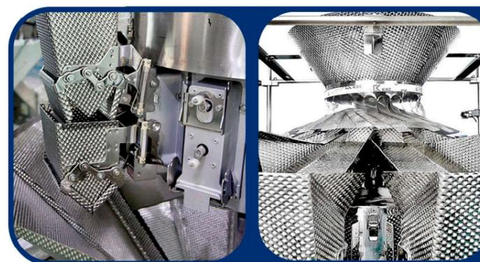
Soluciones para alimentación, adaptando, material, forma y recubrimiento de las zonas de contacto para asegurar un flujo constante de producto y continuidad en la alimentación de la envasadora.
