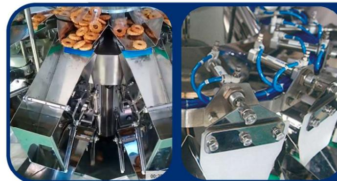
Solución con cono, palas y tolvas inclinados para aumentar el control sobre la velocidad del producto y evitar roturas en producto frágil. Posibilidad de trabajar con diferentes materiales y recubrimientos de tolva.
