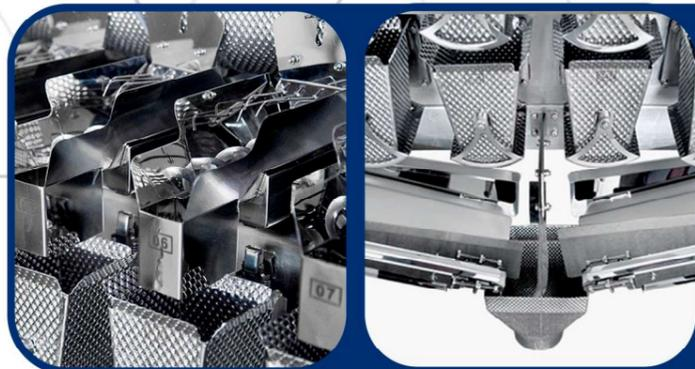
Todas las partes en contacto con el producto están diseñadas para una limpieza, mantenimiento y extracción fácil y con materiales según normativa.
